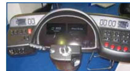
TEQ Nuovo cruscotto digitale con due display integrati che sostituiscono tutti gli strumenti.
