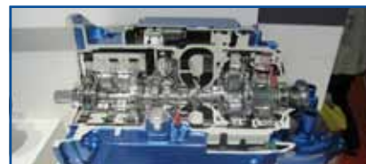
VOITH Con il cambio automatico Diwa.6, l'Aquatarder SWR e il compressore aria.
