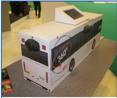
AEC - Visuale senza angoli morti con la soluzione Bird Eye 360° a quattro telecamere.
